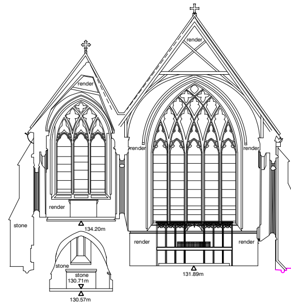
3 EXISTING SECTION E-E Scale: 1:200
